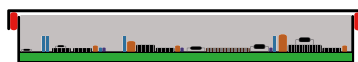
Figure 06 Boîtier électronique encapsulé + Étanchéité du couvercle du boîtier électronique par un joint ► Protection contre les impacts, poussières, débris et immersion
