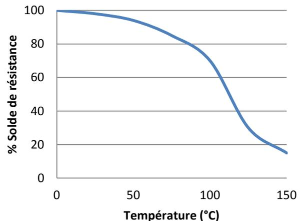
Essais en cisaillement à chaud réalisés sur des assemblages verre sur acier doux. Les échantillons sont entièrement polymérisés avant d'être mis en température pendant 30 minutes avant réalisation des essais. UV625 peut être soumis sous faible contrainte mécanique à des températures plus élevées. Par exemple Thermo-laquage, soudage. Température minimale après polymérisation: -55°C (-65°F) dépendant des matériaux.
