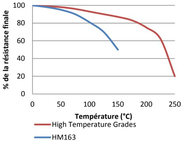
“Dureté à chaud” l'évolution du couple de rupture en fonction du temps sur des boulons M10 en acier zingué selon la norme ISO 10964. Polymérisation de 24 heures à 23°C. Puis conditionnement de 30 minutes à des températures montrées dans le graphique.
