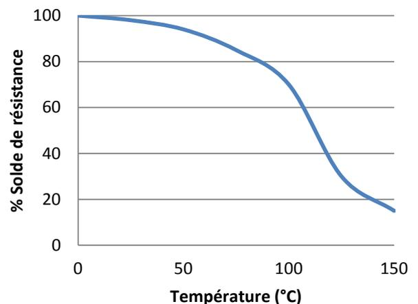
Essais en cisaillement à chaud réalisés sur des assemblages verre sur acier doux. Les échantillons sont entièrement polymérisés avant d'être mis en température pendant 30 minutes avant réalisation des essais. UV675 peut être soumis sous faible contrainte mécanique à des températures plus élevées. Par exemple Thermo-laquage, soudage. Température minimale après polymérisation: -55°C (-65°F) dépendant des matériaux.
