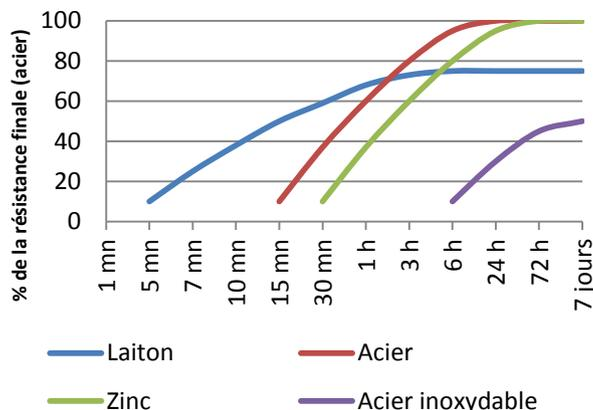
Ces données sont typiques pour des surfaces acier à 23°C. Le cuivre et les alliages cuivreux donnent une polymérisation plus rapide. Les surfaces oxydées ou passivées ainsi que le zinc donnent une polymérisation plus lente. Une température basse ou un jeu important ralentiront aussi la polymérisation. Pour réduire le temps de polymérisation nous préconisons l'utilisation de notre activateur Permabond A905 ou de chauffer l'assemblage dans la mesure du possible.
