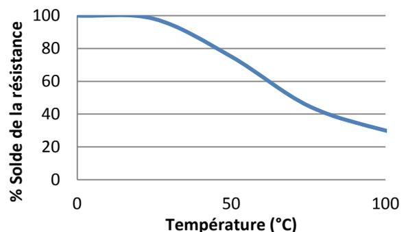
Essais de cisaillement en température réalisés sur l'acier doux. Polymérisation complète à température ambiante, puis mise en température durant 30 minutes avant réalisation des essais.
