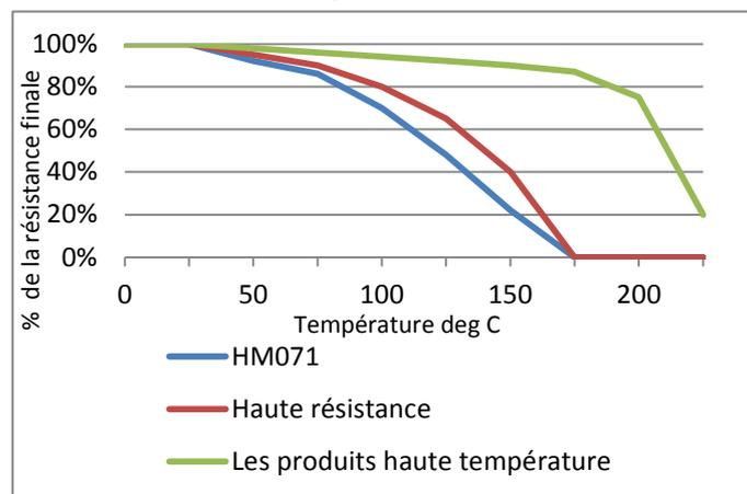
Essais de cisaillement en température réalisés sur l'acier doux. Polymérisation de 24h à température ambiante, puis mise en température durant 30 minutes avant réalisation des essais.
