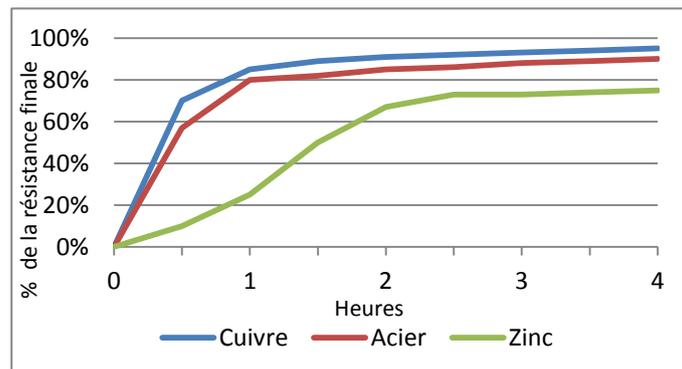
Ces données sont typiques pour des surfaces acier à 23°C. Le cuivre et les alliages cuivreux donnent une polymérisation plus rapide. Les surfaces oxydées ou passivées ainsi que le zinc donnent une polymérisation plus lente. Une température basse ou un jeu important ralentiront aussi la polymérisation. Pour réduire le temps de polymérisation nous préconisons l'utilisation de notre activateur Permabond A905 ou de chauffer l'assemblage dans la mesure du possible.
