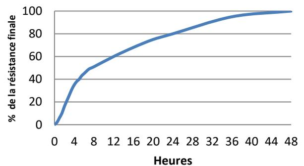
Le graphique ci-dessus montre l'évolution typique de la résistance pour des pièces collées à une température de 23°C. Une température plus élevée ou plus basse risque de changer la vitesse de polymérisation.
