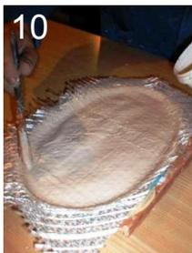
9. déposer la seconde couche de fibre 200-4D et la faire pénétrer dans le produit.
