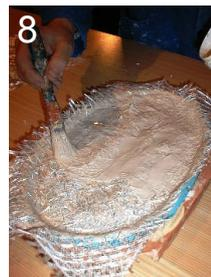
Ces étapes illustrent une technique simple destinée à augmenter l'espace entre les 2 couches de fibre 200-4D afin de rigidifier des panneaux stratifiés de grande dimension. Plus cet espace est important, plus le panneau est rigide.
