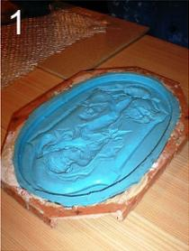
1. préparer le moule pour la stratification. Si le moule n'est pas en silicone, il est impératif d'appliquer un produit démoulant.
