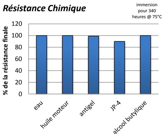
**Ce produit n'est pas recommandé pour une utilisation en contact avec de la vapeur d'eau, des substances fortement oxydantes ou des solvants polaires, bien qu'il puisse résister à des nettoyages au solvant sans détérioration de ses propriétés adhésives.**
