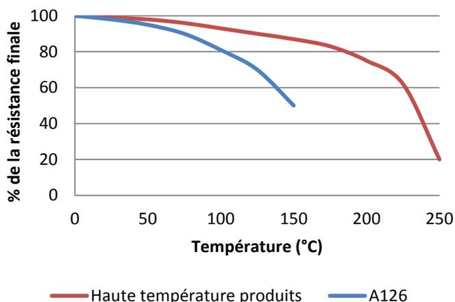
*"Dureté à chaud" l'évolution du couple de rupture en fonction du temps sur des boulons M10 en acier zingué selon la norme ISO 10964.*
