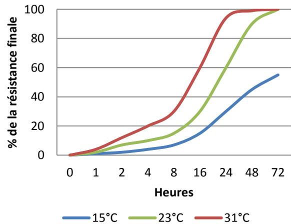
Ce graphique montre un développement typique de la résistance des composants collés. Une augmentation de la température de 8° réduira de moitié le temps de polymérisation. Les plus basses les températures, le plus long le temps de polymérisation.
