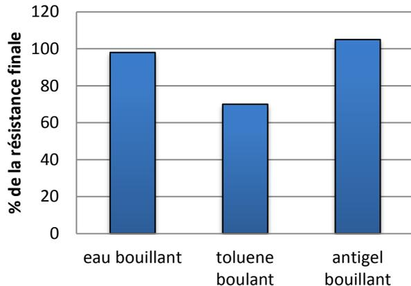
**Ce produit n'est pas recommandé pour une utilisation en contact avec de la vapeur d'eau, des substances fortement oxydantes ou des solvants polaires, bien qu'il puisse résister à des nettoyages au solvant sans détérioration de ses propriétés adhésives.**
